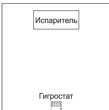
Рисунок 5: Место установки датчика влажности/комбинированного датчика скамьи
