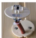
4. Сигнальный кабель датчика подключить к плате согласно схеме электрических соединений.
